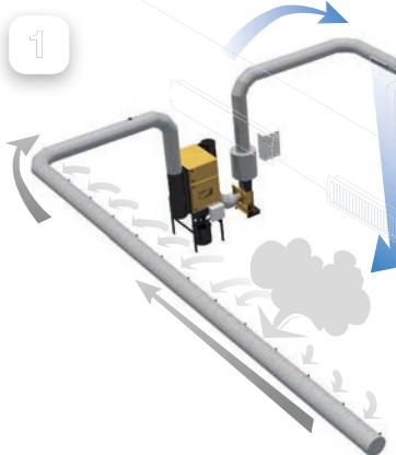
1. Система Push-Pull проектируется исходя из конфигурации цеха заказчика. Дальнобойность сопел достигает 24 м. Требуется монтаж воздуховодов.
