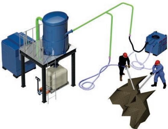
В зависимости от свойств собираемого материала и условий эксплуатации поставляемое оборудование может различаться по типу исполнения – общепромышленное, взрывозащищенное, химстойкое.
