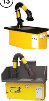
Столы сварщика производительностью 1200 м<sup>3</sup>/ч со встроенными самоочищающимся фильтром и вентилятором. Столы укомплектованы вытяжным устройством КУА (Ø 160 мм, длина 2 м). Защитные экраны из металла и гибких полос, поворотный столик и рабочее освещение входят в комплект поставки моделей ССМ-1200 и являются опциональными для ССБ-1200.
