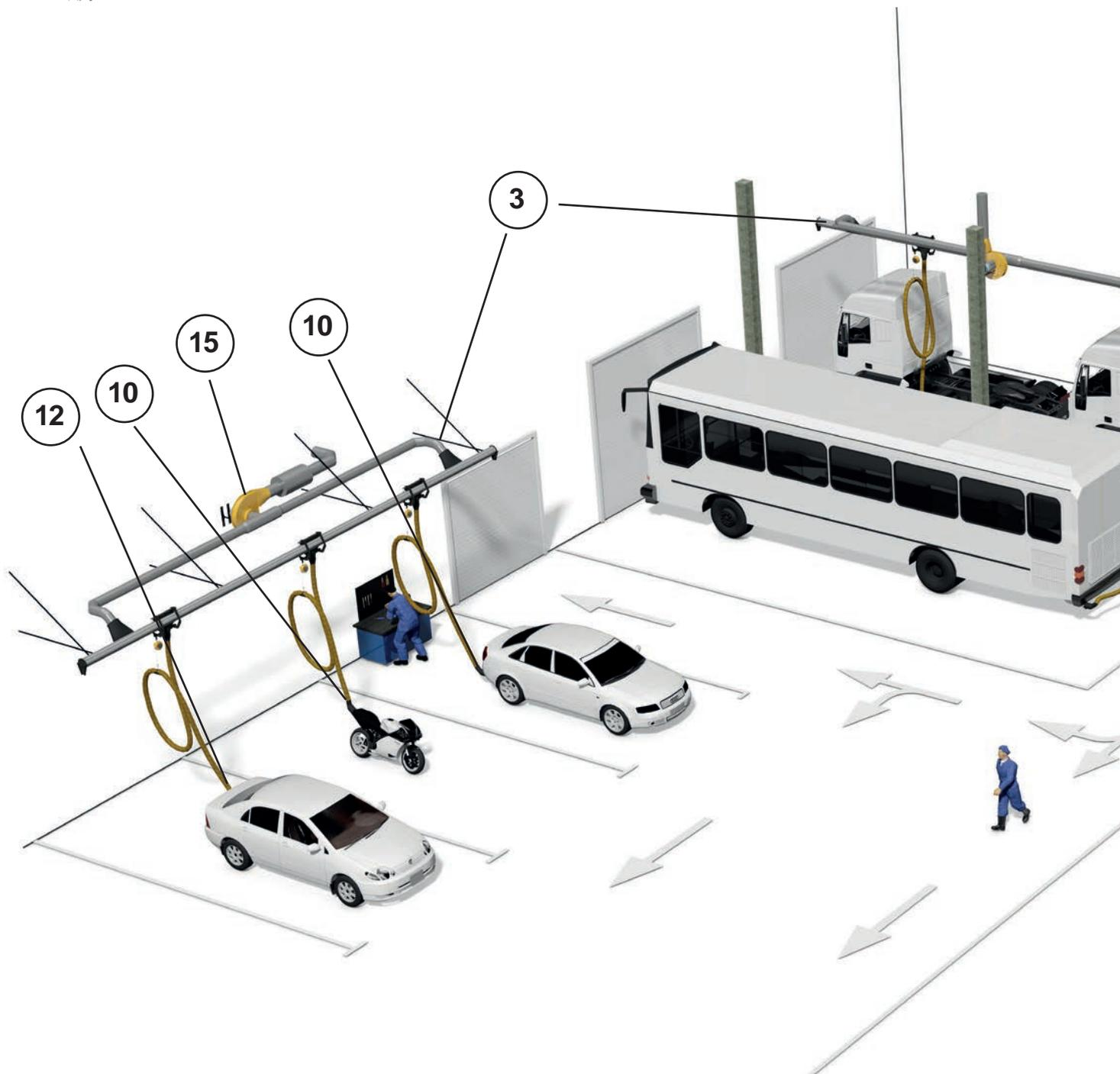
Обычная вентиляционная система не может обеспечить ПДК вредных веществ, частицы выхлопных газов очень тяжелые и оседают в рабочей зоне персонала, поэтому сначала все эти газы пройдут через дыхательные пути, а уже потом будут разбавлены вентиляцией.
