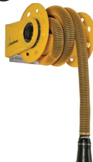
Вытяжные катушки с электроприводом для удаления выхлопных газов от крупногабаритных транспортных средств. Для помещений с высокими потолками и шлангов большего диаметра. Для шлангов  $\varnothing$ 75–100 мм и длиной 5–12,5 м.
