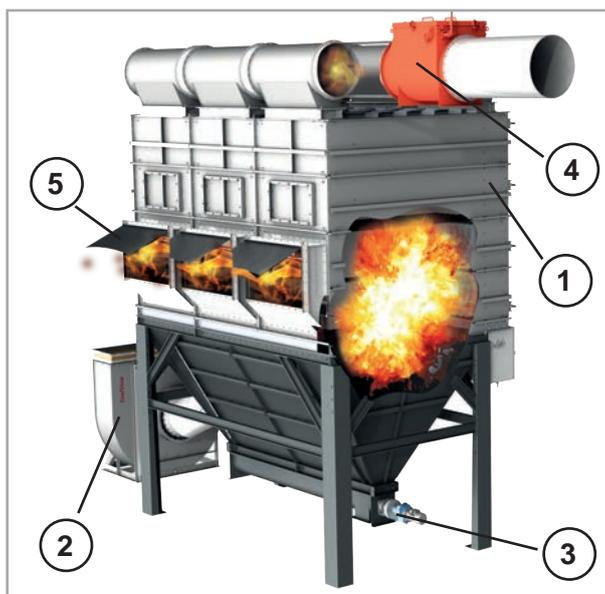
1. Фильтр с усиленным корпусом и бункером на взрывное давление до 0,4 бар;
