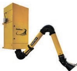
Навесной механический самоочищающийся фильтр с вертикальным картриджем, встроенным вентилятором в шумопоглощающем корпусе и выходом воздуха вверх, встроенным компрессором, для сварки, зачистки, шлифовки и аналогичных видов пыли. Для одного вытяжного устройства Ø 160 мм. Максимальный расход воздуха 1200 м³/ч.
