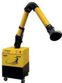
Передвижной фильтр для: пайки, лазерной маркировки, гравировки, сварки низкой интенсивности, в т.ч. контактной, - с кассетой HEPA H13; для Летучих органических соединений (ЛОС) и некоторых токсичных газов - с кассетой из насыпного активированного угля. Максимальная производительность - 1200 м³/час.
