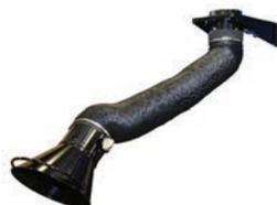
Компактное телескопическое вытяжное устройство (Ø160 мм) для удаления сварочных дымов, масляных туманов, пыли и других загрязнений на небольших рабочих местах и в помещениях с низкими потолками. Рассчитано на расход воздуха до 1200 м<sup>3</sup>/ч.
