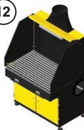
Профессиональный вытяжной стол с открывающимися защитными экранами для удаления пыли и дымов от интенсивных видов сварки и зачистки через решетку столешницы и вертикальную панель на задней стенке. Подключается к внешней фильтровентиляционной установке производительностью 2500–3000 м<sup>3</sup>/ч.
