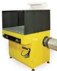
Профессиональный вытяжной стол с защитными экранами из гибких полос для удаления пыли и дымов от легких видов сварки и зачистки через вытяжную решетку, занимающую всю площадь столешницы. Подключается к внешней фильтровентиляционной установке производительностью 1200–2500 м<sup>3</sup>/ч.
