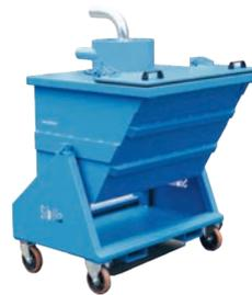
Применение пресепаратора позволяет значительно расширить диапазон собираемых материалов, включая сбор разливов не взрывоопасных жидкостей.
