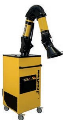
Передвижной механический самоочищающийся фильтр для сварки и зачистки, а также улавливания других аналогичных видов пыли. Система автоматической очистки сжатым воздухом по перепаду давления ( $\Delta P$ -функция). Есть встроенный компрессор. На выбор два механизма самоочистки: импульсная (со вставкой-рассекателем) и с ротационным соплом. Опциональный угольный фильтр от газов и запахов. Два небольших лотка-пылесборника для удобства обслуживания. Увеличенная производительность до 1400 м³/ч.
