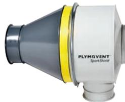
Циклон-искрогаситель для предварительной фильтрации и защиты фильтровентиляционной системы от попадания искр и сварочных брызг, образующихся во время сварки, резки, зачистки и других процессов металлообработки. Является эффективным предварительным фильтром, снижающим пылевую нагрузку на фильтровентиляционную систему.
