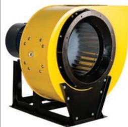
Вентиляторы центробежные с расширенным диапазоном производительности, расходом воздуха до 25000 м<sup>3</sup>/ч, давлением от 2800 до 5400 Па. Корпус стальной, сварной в форме улитки. Рабочее колесо стальное, сварное, окрашенное. Все модели вентиляторов данной серии имеют исполнение в полноразмерном шумопоглощающем корпусе с инспекционной дверцей.
