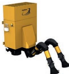
Навесной механический самоочищающийся фильтр с двумя вертикальными картриджами, встроенным вентилятором в шумопоглощающем корпусе и выходом воздуха вверх для сварки, зачистки, шлифовки и аналогичных видов пыли. Для одного вытяжного устройства Ø 200 мм или двух устройств Ø 160 мм. Рассчитан на большую производительность (до 2400 м³/ч).
