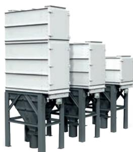
Модульные самоочищающиеся фильтры с плоскими карманами и импульсной системой очистки сжатым воздухом для непрерывной очистки воздуха или газов от различных видов сухой, сыпучей пыли, а также от волокнистой и слабослипающейся пыли с входной концентрацией до  $50 \text{ г/м}^3$ . Площадь фильтрующей поверхности одного модуля составляет от  $36$  до  $126 \text{ м}^2$ . Производительность до  $150 \text{ тыс. м}^3/\text{ч}$ .
