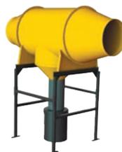
Блок циклонов прямоточных с опорами для улавливания крупно- и среднедисперсной пыли. Производительность 10000 м³/ч. Монтируется в прямолинейный участок воздуховода.
