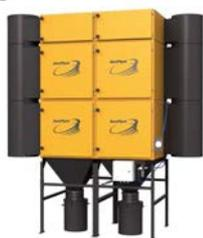
Модульный самоочищающийся фильтр с горизонтальными картриджами для термической резки, сварки, зачистки и шлифовки металлов и других аналогичных процессов обработки различных материалов. Рекомендуемая начальная концентрация пыли до 2 г/м³. Доступен в различных конфигурациях от 2 до 64 фильтрующих картриджей (расход воздуха 600–64000 м³/ч).
