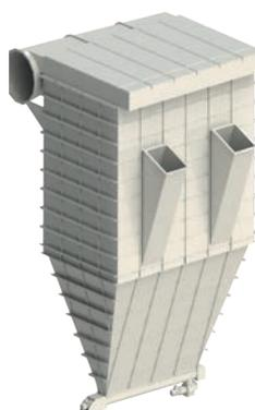
Рукавный фильтр с импульсной регенерацией — классический и наиболее универсальный по области применения тканевый фильтр. Достигать необходимой производительности возможно как путем добавления секций в конструкцию фильтра, так и с помощью батарейной компоновки нескольких фильтров. Аспирационные газы с высоким содержанием пыли (до  $60 \text{ г/м}^3$ ). Аппараты очистки большой производительности от  $15 \text{ тыс. м}^3/\text{ч}$  до  $1,5\text{--}2,0 \text{ млн. м}^3/\text{ч}$ .
