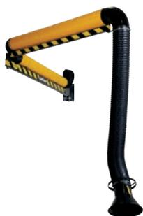
Консольно-поворотное вытяжное устройство (Ø160 мм) с вертикальным телескопическим механизмом для удаления сварочных аэрозолей и аналогичных видов дыма. Рассчитано на расход воздуха до 1200 м<sup>3</sup>/ч.
