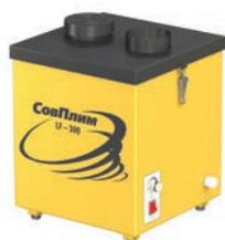
Портативный фильтр для пайки для одного-двух настольных вытяжных устройств. Низкий уровень шума, регулировка производительности, комбинированный фильтр (HEPA + активированный уголь). Максимальный расход воздуха 320 м³/ч.
