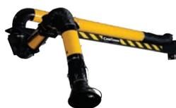
Консольное подъемно-поворотные вытяжные устройства для удаления сварочных дымов, масляных туманов, пыли и других загрязнений. FM-M (Ø160 мм) рассчитаны на расход воздуха до 1200 м<sup>3</sup>/ч. FM-200 (Ø200 мм) имеют увеличенную производительность до 2000 м<sup>3</sup>/ч.
