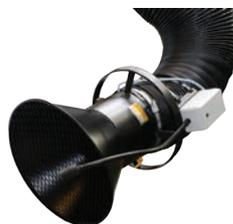
Световой датчик на вытяжной воронке фиксирует момент начала/завершения сварки по световому излучению. Является альтернативой индукционному датчику для сварки силой тока менее 30 А и газовой сварки.
