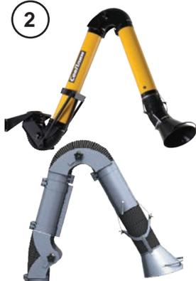
Подъемно-поворотные вытяжные устройства для удаления сварочных дымов, масляных туманов, пыли и других загрязнений. KUA-M (Ø160 мм) рассчитаны на расход воздуха до 1200 м<sup>3</sup>/ч. KUA-200 (Ø200 мм) имеют увеличенную производительность до 2000 м<sup>3</sup>/ч. Данные изделия также доступны в исполнении из нержавеющей стали.
