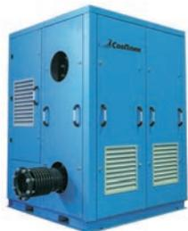
Вакуумный насос VPR, на основе насоса Рутса, создает высокое разрежение, что позволяет обеспечить требуемое разрежение и расход воздуха в гибких шлангах и трубопроводах. Насос с дополнительным каналом охлаждения позволяет работать с системами высокой протяженности (>200 м) и подходит для транспортировки тяжелых, «проблемных» материалов (уд. вес >2 т/м³). Производительность от 875 м³/ч до 2930 м³/ч. Разрежение до -50 кПа
