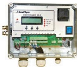
Пульт управления (ведущий) для фильтров с системой автоматической очистки картриджей сжатым воздухом. Комплектуется контроллером управления до 24 пневматических клапанов. Оснащен электронным дифференциальным манометром с  $\Delta P$ -функцией, включающей систему очистки по заданному значению загрязненности картриджей.
