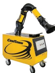
Передвижной механический самоочищающийся фильтр для сварки и зачистки, а также улавливания других аналогичных видов пыли. Система автоматической очистки работает по таймеру. Требуется внешний источник сжатого воздуха. Максимальный расход воздуха 1200 м³/ч.
