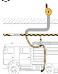
Это оптимальное решение для гаражей служб быстрого реагирования с одним парковочным местом. Система SBT подходит для обслуживания транспортных средств с выхлопными трубами расположенными в нижней или задней части. Длины систем 6 и 9 м. Комплектуется пневмонасадкой и быстроразъемной муфтой.
