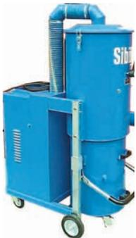
Универсальный промышленный пылесос предназначен для обеспыливания технологических процессов либо для уборки пыли и просыпей материала.
