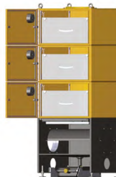
Сливная трубка для масла Собранное масло может сливаться в коллектор или возвращаться обратно в машину.
