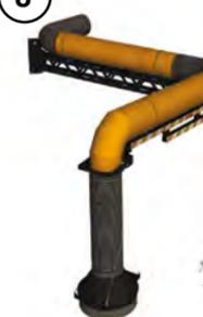
Вытяжное устройство для тепловозов. Устанавливается в железнодорожных депо. Стоит из консольно-поворотной балки, с закрепленным на ней вытяжным устройством с магнитной воронкой. Выхлопные газы удаляются вытяжным вентилятором через гибкий шланг и воздуховод.
