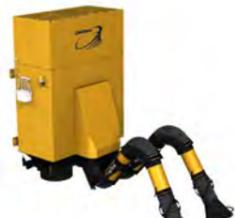
Навесной механический самоочищающийся фильтр с двумя вертикальными картриджами, встроенным вентилятором в шумопоглощающем корпусе и выходом воздуха вверх для сварки, зачистки, шлифовки и аналогичных видов пыли. Для одного вытяжного устройства  $\varnothing$  200 мм или двух устройств  $\varnothing$  160 мм. Рассчитан на большую производительность (до 2400 м<sup>3</sup>/ч).
