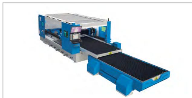
Газо-плазменная резка в компактном исполнении
