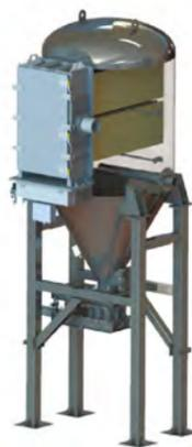
Фильтр-сепаратор SFV является совмещенным устройством, осуществляющим гравитационное осаждение транспортируемого вакуумной системой материала в емкости бункера и очистку транспортируемого воздуха. Очистка отработавшего воздуха осуществляется во встроенном карманном фильтре с импульсной регенерацией сжатым воздухом. Производительность от 1000 м³/ч до 3400 м³/ч. Разрежение до -50 кПа
