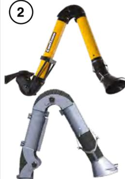
Подъемно-поворотные вытяжные устройства для удаления сварочных дымов, масляных туманов, пыли и других загрязнений. KUA-M (Ø160 мм) рассчитаны на расход воздуха до 1200 м³/ч. KUA-200 (Ø200 мм) имеют увеличенную производительность до 2000 м³/ч. Данные изделия также доступны в исполнении из нержавеющей стали.
