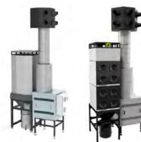
Автономно работающие фильтровентиляционные системы, предотвращающие накопление сварочных дымов на производстве путем постоянной фильтрации загрязненного воздуха внутри помещения. Состоят из центрального фильтра системы (в системах SCS-Diluter Go) или блока фильтров (в системе MDB-Diluter PRO), вентилятора в шумопоглощающем кожухе, воздухораспределительного устройства Diluter с регулируемыми напорными соплами и шумоглушителя.
