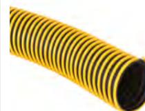
Для комплектации вытяжных устройств и применения в системах удаления выхлопных газов. Три основных модели для разных температур: EH-PV (до +150°C), EG (до +200°C), EF (до +300°C)
