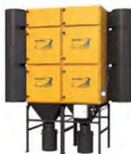
Модульный самоочищающийся фильтр с горизонтальными картриджами для термической резки, сварки, зачистки и шлифовки металлов и других аналогичных процессов обработки различных материалов. Рекомендуемая начальная концентрация пыли до 2 г/м<sup>3</sup>. Доступен в различных конфигурациях от 2 до 64 фильтрующих картриджей (расход воздуха 600–64000 м<sup>3</sup>/ч).
