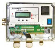
Пульт управления (ведущий) для фильтров с системой автоматической очистки картриджей сжатым воздухом. Комплектуется контроллером управления до 24 пневматических клапанов. Оснащен электронным дифференциальным манометром с ДР-функцией, включающей систему очистки по заданному значению загрязненности картриджей.
