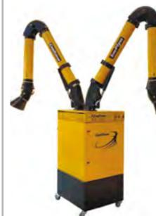
Передвижной механический самоочищающийся фильтр для сварки и зачистки, а также улавливания других аналогичных видов пыли. Система автоматической очистки сжатым воздухом по перепаду давления (ΔP-функция). Есть встроенный компрессор. Опциональный угольный фильтр от газов и запахов. Есть модификации для двух вытяжных устройств Ø160 мм или для одного вытяжного устройства Ø160 мм или Ø200 мм. Рассчитан на большую производительность (до 2400 м³/ч).
