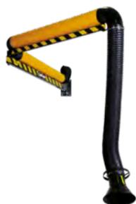
Консольно-поворотное вытяжное устройство (Ø160 мм) с вертикальным телескопическим механизмом для удаления сварочных аэрозолей и аналогичных видов дыма. Рассчитано на расход воздуха до 1200 м³/ч.
