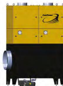
Модульные фильтры масляного тумана на базе ME-31/32. Количество вертикальных модулей варьируется от 2 до 5. Количество ступеней очистки либо 4, либо 5 (вместе с HEPA). Производительность от 6000 до 15000 м³/ч.
