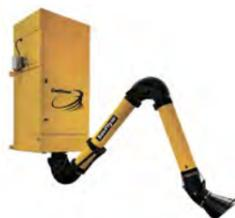
Навесной механический самоочищающийся фильтр с вертикальным картриджем, встроенным вентилятором в шумопоглощающем корпусе и выходом воздуха вверх, встроенным компрессором, для сварки, зачистки, шлифовки и аналогичных видов пыли. Для одного вытяжного устройства  $\varnothing$  160 мм. Максимальный расход воздуха 1200 м<sup>3</sup>/ч.
