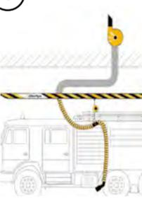
Это оптимальное решение для гаражей служб быстрого реагирования с одним парковочным местом. Система SBT подходит для обслуживания транспортных средств с выхлопными трубами расположенными в нижней или задней части. Длины систем 6 и 9 м.
