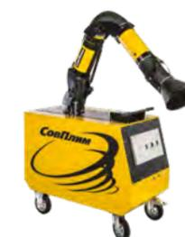
Передвижной механический самоочищающийся фильтр для сварки и зачистки, а также улавливания других аналогичных видов пыли. Система автоматической очистки работает по таймеру. Требуется внешний источник сжатого воздуха. Максимальный расход воздуха 1200 м³/ч.
