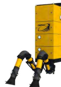
Навесная версия фильтров с картриджами накопительными типа с возможностью подключения одного или двух вытяжных устройств КУА. Количество модулей определяется количеством ступеней фильтрации (предварительный, основной, HEPA, уголь). Есть модификации со встроенным вентилятором в шумопоглощающем корпусе.
