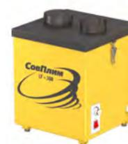
Портативный фильтр для пайки для одного-двух настольных вытяжных устройств. Низкий уровень шума, регулировка производительности, комбинированный фильтр (HEPA + активированный уголь). Максимальный расход воздуха 320 м³/ч.
