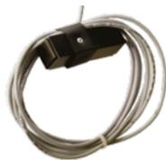
Индукционный датчик фиксирует момент начала/прекращения сварки по наличию электрического тока. Крепится на нулевом проводе сварочного аппарата.
