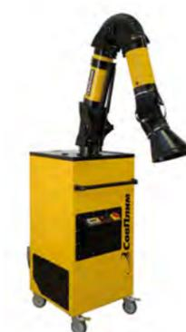
Передвижной механический самоочищающийся фильтр для сварки и зачистки, а также улавливания других аналогичных видов пыли. Система автоматической очистки сжатым воздухом по перепаду давления (ΔP-функция). Есть встроенный компрессор. На выбор два механизма самоочистки: импульсная (со вставкой-рассекателем) и с ротационным соплом. Опциональный угольный фильтр от газов и запахов. Два небольших лотка-пылесборника для удобства обслуживания. Увеличенная производительность до 1400 м³/ч.
