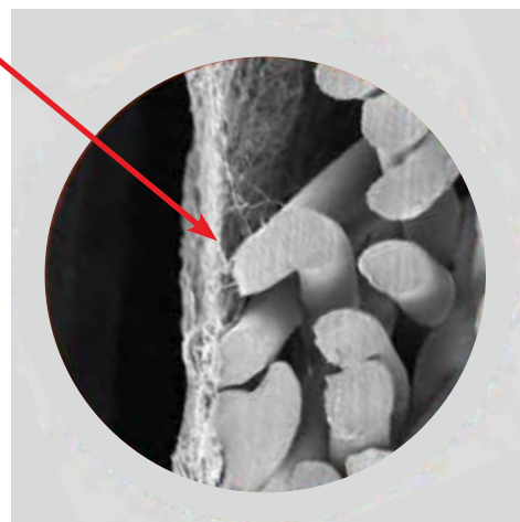
Материал PTFE мембраны. Даже мельчайшие частицы пыли задерживаются на поверхности материала.
