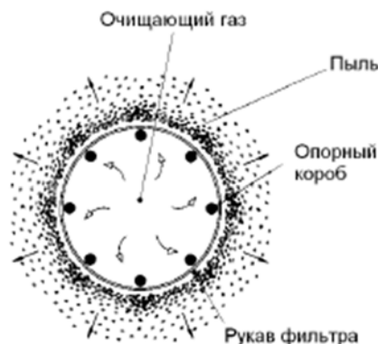
Рисунок 4.7 - Поперечный разрез рукава фильтра (фаза регенерации)
