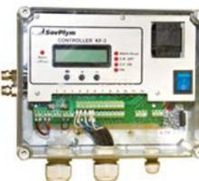
Пульт управления (ведущий) для фильтров с системой автоматической очистки картриджом сжатым воздухом. Комплектуется контроллером управления до 24 пневматических клапанов. Оснащен электронным дифференциальным манометром с  $\Delta P$ -функцией, включающей систему очистки по заданному значению загрязненности картриджа.
