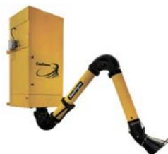
Навесной механический самоочищающийся фильтр с вертикальным картриджем, встроенным вентилятором в шумопоглощающем корпусе и выходом воздуха вверх, встроенным компрессором, для сварки, зачистки, шлифовки и аналогичных видов пыли. Для одного вытяжного устройства Ø160 мм.
