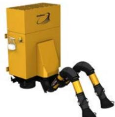
Навесной механический самоочищающийся фильтр с двумя вертикальными картриджами, встроенным вентилятором в шумопоглощающем корпусе и выходом воздуха вверх для сварки, зачистки, шлифовки и аналогичных видов пыли. Для одного вытяжного устройства Ø200 мм или двух устройств Ø160мм.
