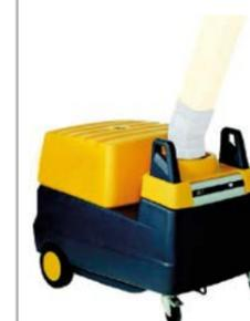
Пластиковые мобильные агрегаты. MFD – фильтр накопительного типа для сварки низкой интенсивности, MFS – фильтр с системой самоочистки (опционально со встроенным компрессором сжатого воздуха) для сварки высокой интенсивности, MFE – электростатический фильтр для работы с замасленными металлами. Максимальный расход воздуха агрегатов 1250–1300 м³/ч. Из особенностей фильтров можно выделить относительно небольшой вес и компактные габариты.
