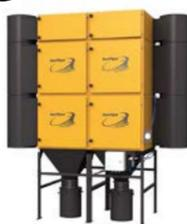
Модульный самоочищающийся фильтр с горизонтальными картриджами для термической резки, сварки, зачистки и шлифовки металлов и других аналогичных процессов обработки различных материалов. Рекомендуемая начальная концентрация пыли до 2 г/м<sup>3</sup>. Доступен в различных конфигурациях от 2 до 64 фильтрующих картриджей (расход воздуха 600–64000 м<sup>3</sup>/ч).
