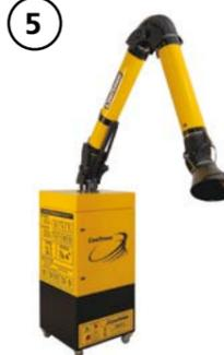
Передвижной механический самоочищающийся фильтр для процессов сварки и зачистки, а также улавливания других аналогичных видов пыли. Преимущества: система очистки с ΔP-функцией; вертикальный быстросъемный фильтрующий картридж; встроенный компрессор; низкий уровень шума, фильтр предварительной очистки сетчатый.
