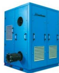
Вакуумный насос VPR, на основе насоса Рутса, создаёт высокое разрежение, что позволяет обеспечить требуемое разрежение и расход воздуха в гибких шлангах и трубопроводах. Насос с дополнительным каналом охлаждения позволяет работать с системами высокой протяженности (>200 м) и подходит для тяжелых «проблемных» материалов (уд. вес >2 т/м<sup>3</sup>). Производительность от 875 м<sup>3</sup>/ч до 2930 м<sup>3</sup>/ч. Разрежение до -50 кПа
