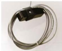
Индукционный датчик фиксирует момент начала/прекращения сварки по наличию электрического тока. Крепится на нулевом проводе сварочного аппарата.
