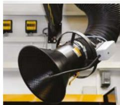
Световой датчик на вытяжной воронке фиксирует момент начала/завершения сварки по световому излучению. Является альтернативой индукционному датчику для сварки силой тока менее 30 А и газовой сварки.
