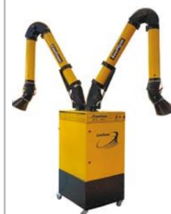
Передвижной механический самоочищающийся фильтр для процессов сварки и зачистки, а также улавливания других аналогичных видов пыли. Дополнительно предусмотрена установка фильтра из активированного угля от газов и запахов. Увеличенная производительность до 2400 м³/ч. Варианты исполнения: с двумя вытяжными устройствами для одновременной работы на двух постах; с одним вытяжным устройством увеличенного диаметра 200 мм; с одним стандартным вытяжным устройством Ø160 мм.
