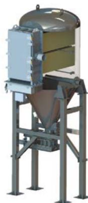
Фильтр-сепаратор SFV является совмещенным устройством, осуществляющим гравитационное осаждение транспортируемого вакуумной системой материала в емкости бункера и очистку транспортируемого воздуха. Очистка отработавшего воздуха осуществляется во встроенном карманном фильтре с импульсной регенерацией сжатым воздухом. Производительность от 1000 м<sup>3</sup>/ч до 3400 м<sup>3</sup>/ч. Разрежение до -50 кПа
