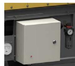
Пульт управления для фильтров с системой автоматической очистки картриджом сжатым воздухом. Комплектуется контроллером управления до 32 пневматических клапанов. Очистка картриджа производится по заданному значению частоты и длительности импульсов сжатого воздуха.
