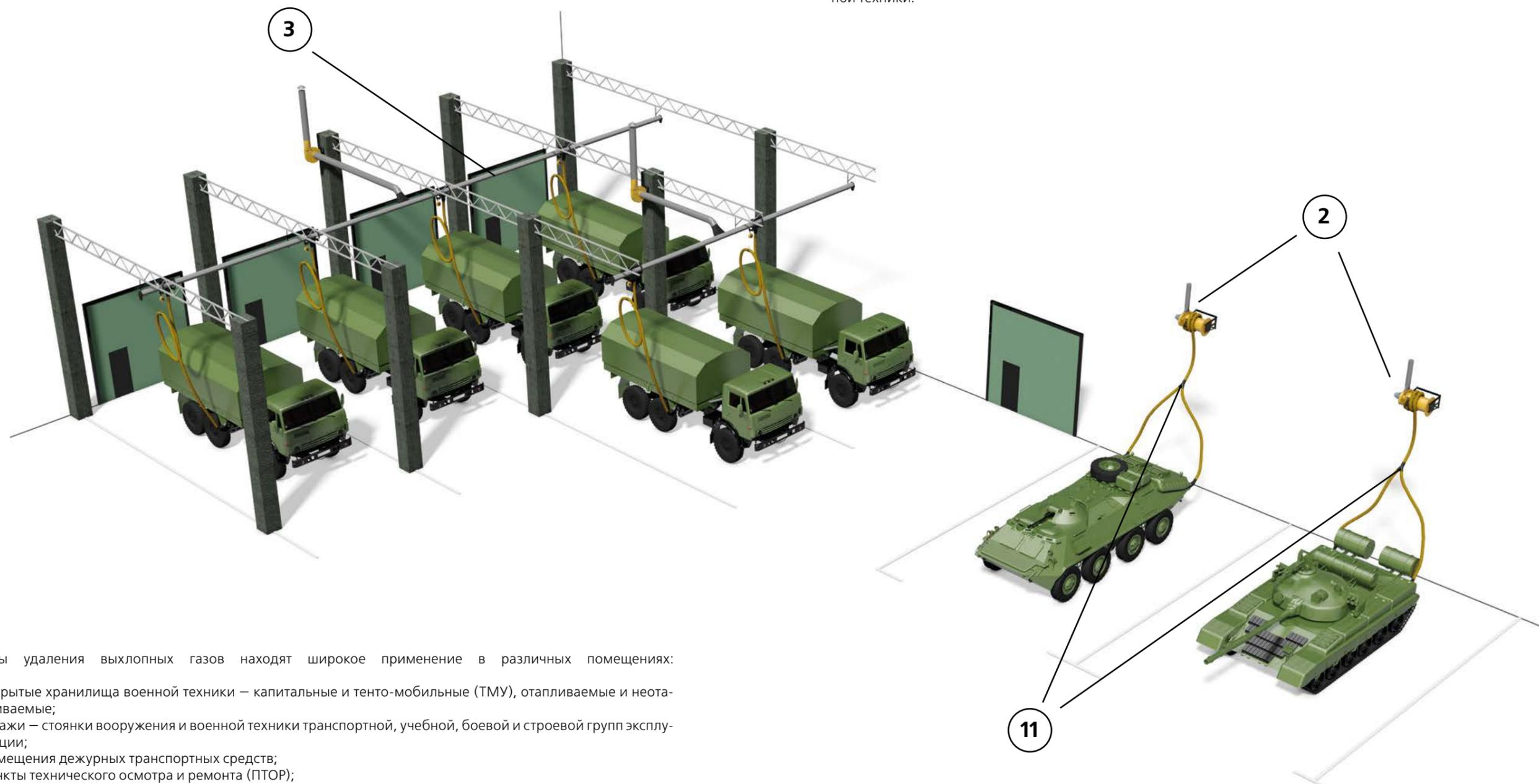
Системы удаления выхлопных газов находят широкое применение в различных помещениях:
