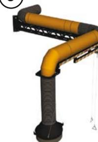
Вытяжное устройство для тепловозов. Устанавливается в железнодорожных депо. Состоит из консольно-поворотной балки, с закрепленным на ней вытяжным устройством с магнитной воронкой. Выхлопные газы удаляются вытяжным вентилятором через гибкий шланг и воздуховод.
