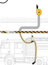
Это оптимальное решение для гаражей служб быстрого реагирования с одним парковочным местом. Система SBT подходит для обслуживания транспортных средств с выхлопными трубами расположенными в нижней или задней части. Длины систем 6 и 9 м.
