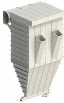
Рукавный фильтр с импульсной регенерацией — классический и наиболее универсальный по области применения тканевый фильтр. Достигать необходимой производительности возможно как путем добавления секций в конструкцию фильтра, так и с помощью батарейной компоновки нескольких фильтров. Аспирационные газы с высоким содержанием пыли (до 60 г/м<sup>3</sup>). Аппараты очистки большой производительности от 15 тыс. м<sup>3</sup>/ч до 1,5–2,0 млн. м<sup>3</sup>/ч.
