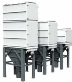
Модульные самоочищающиеся фильтры с плоскими карманами и импульсной системой очистки сжатым воздухом для непрерывной очистки воздуха или газов от различных видов сухой, сыпучей пыли, а также от волокнистой и слабослипающейся пыли с входной концентрацией до 50 г/м<sup>3</sup>. Площадь фильтрующей поверхности одного модуля составляет от 36 до 126 м<sup>2</sup>. Производительность до 150 тыс. м<sup>3</sup>/ч.
