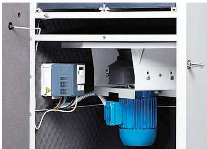
ВСРОЕННЫЙ ВЕНТИЛЯТОР С БЕСПАСНЫМ ПУСКАТЕЛЕМ
