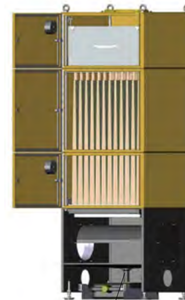
Сливная трубка для масла Собранное масло может сливаться в коллектор или возвращаться обратно в машину.
