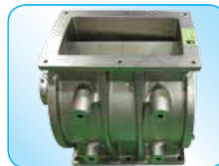
Полное покрытие никелем Используется для продуктов, вызывающих коррозию или как замена нержавеющей стали для применения в пищевой промышленности (там где допустимо). Ротор и фланцы также полностью покрыты никелем.
