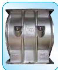
Отверстия для отвода воздуха по бокам предусмотрены стандартно Используются для: - Удаления лишнего воздуха из секторов ротора - Снижения давления воздуха внутри корпуса затвора - Увеличения производительности
