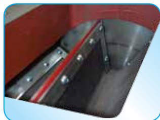
Ротор со сменными накладками
