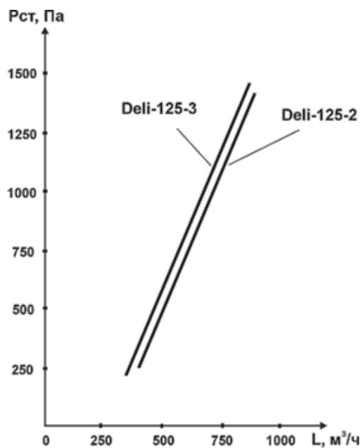
Рисунок А.2 – Графики падения давления устройств DELI-125-S(H)
