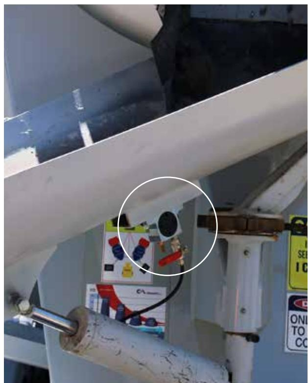
OT (роторный пневматический вибратор) - Желоб для бетоносмесителя.
