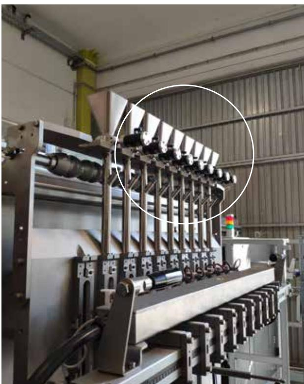
K (линейный пневматический вибратор) - опорожнение бункера
