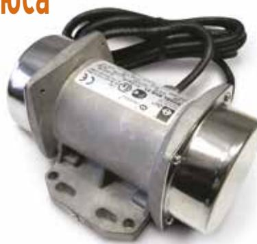
Внешние электрические вибраторы серии MVE-MICRO имеют небольшие размеры и состоят из электродвигателя, заключенного в прочный алюминиевый корпус, с эксцентриковыми грузами, установленными на обоих концах вала.
