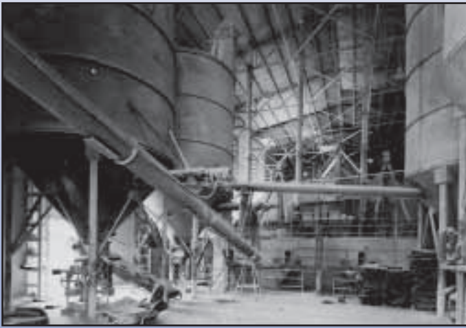
SCREW CONVEYOR FOR TRANSPORT OF RAW MATERIALS FOR CERAMIC GLAZINGS FÖRDERSCHECKE FÜR ROHPRODUKTE ZUR HERSTELLUNG VON KERAMIK EINBRENNEMAILLE VIS TUBULAIRE TRANSPORT MATIERES PREMIERES POUR LAQUES CERAMIQUES COCCLEA TRASPORTO MATERIE PRIME PER SMALTI CERAMICI
