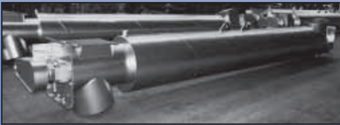
JACKETED COOLING SCREWS CONVEYORS FOR HIGH TEMPERATURE COAL SCHNECKEN MIT KÜHLMANTEL FÜR HEISSE KOHLE VIS TUBULAIRES AVEC CHEMISE DE REFROIDISSEMENT POUR TRANSPORT DE CHARBON A TEMPERATURE TRES ELEVÉE COCCLEA CON CAMICIA DI RAFFREDDAMENTO PER TRASPORTO CARBONE AD ALTISSIMA TEMPERATURA
