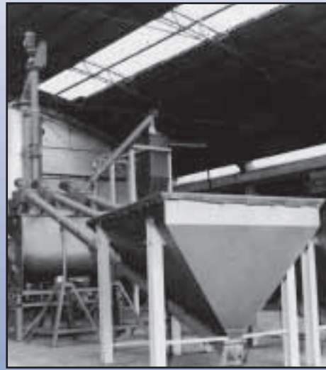
SCREW CONVEYOR FOR CHEMICALS DOSIERSCHNECKE IN CHEMIEFABRIK VIS TUBULAIRE POUR PRODUITS CHIMIQUES COCCLEA PER PRODOTTI CHIMICI
