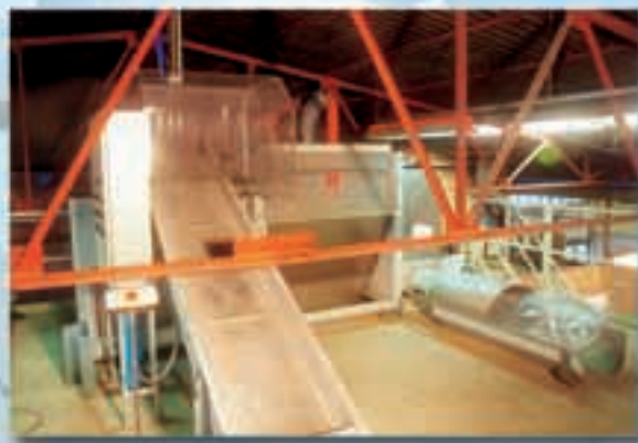
Pneumatic Conveying with Blow-Through-Valve Pneumatische Druckförderung mit Durchblasschleuse Transport pneumatique avec vanne alvéolaire Trasporto pneumatico con rotovalvola
