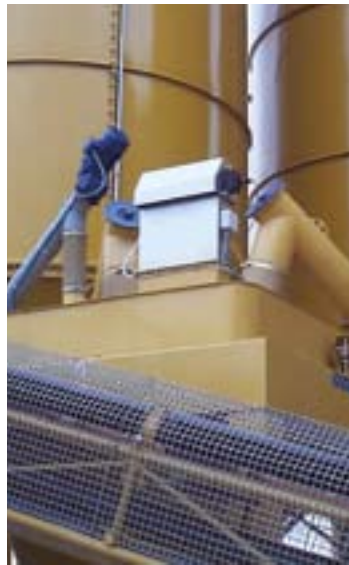
Weigh hopper gravity-fed by silo Behälterwaage unter Silo Trémie alimentée directement par silo Dosatore alimentato da silo
