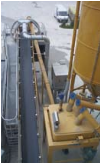
Weigh hopper loaded by screw feeder Behälterwaage durch Dosierschnecke befüllt Trémie alimentée par vis doseuse Dosatore alimentato da coclea estraitrice da silo
