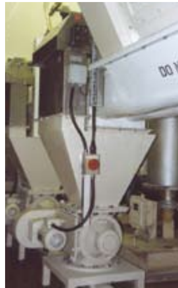
Weigh hopper gravity-fed by silo Behälterwaage unter Silo Trémie alimentée directement par silo Dosatore alimentato da silo
