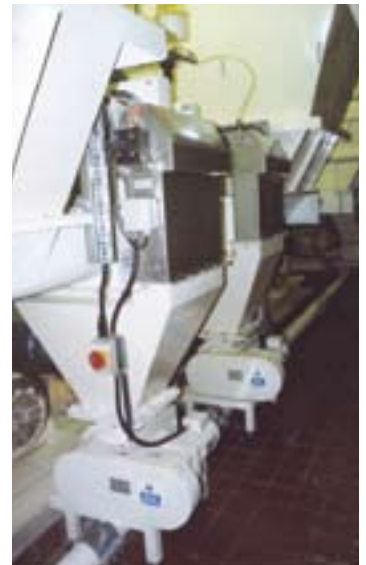
Blow-through rotary valve and pneumatic conveying system Duchblassechleuse und pneumatische Förderung Trémie d'écluse rotative pour transport pneumatique Sfilato rotocella con trasporto pneumatico
