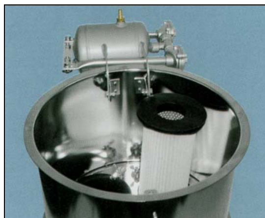
Простая замена фильтрующих элементов со стороны чистого газа.
